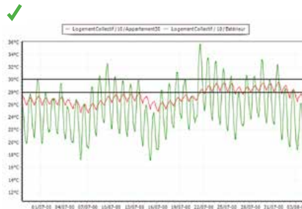
En conception, pour un groupe d'appartements bénéficiant des mêmes conditions, l'évolution des températures intérieures (en rouge) est modélisée en fonction des températures extérieures (en vert). Les périodes où la température intérieure dépasse 28 °C sont identifiées. De nouvelles solutions seront proposées et testées en conception pour améliorer le confort thermique. ©AQC
