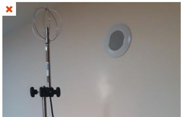
La vitesse omnidirectionnelle de l'air est mesurée à plus de 1,6 m/s à proximité du lit d'un internat, qui n'est plus utilisé en raison de l'inconfort. ©AQC
