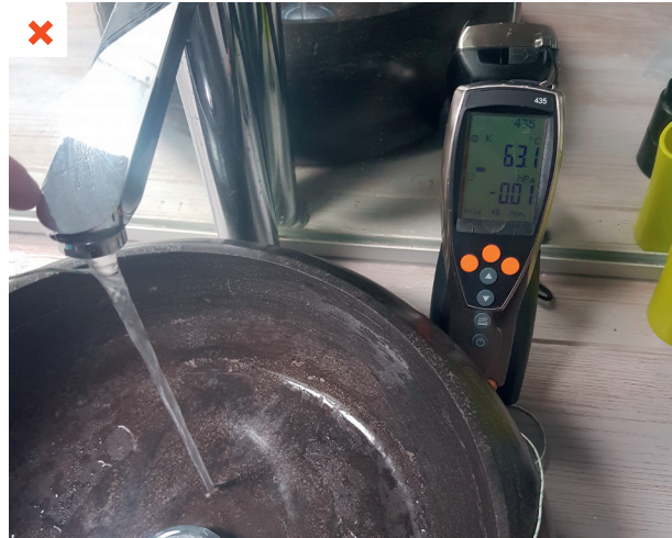
Une mesure au point de puisage montre une température de l'ECS à 63 °C dans la salle de bain. ©AQC
