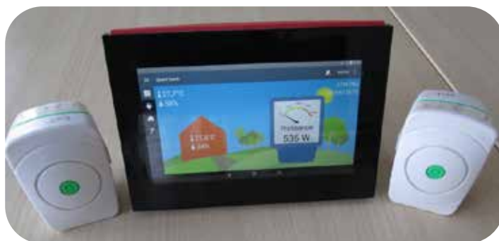
Kit utilisé pour la mesure et l'analyse des consommations électriques et des données confort (température et humidité)
